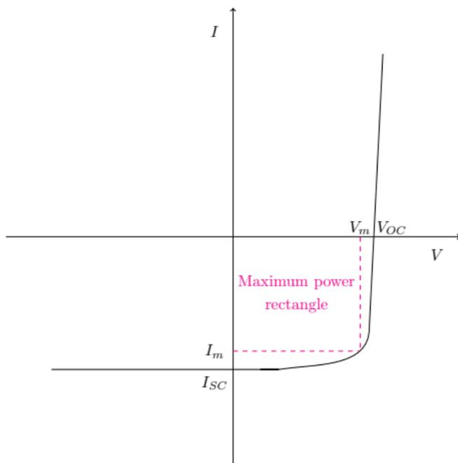
$V_{OC}$  : open circuit voltage ( $R \rightarrow \infty$ )
